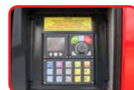
Электронное управление насосом. Утепленный отсек, подогрев водопенных коммуникаций.
