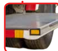
Откидные ступени с нескользящим покрытием. Безопасный и облегченный доступ к ПТВ.
