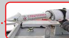
Лафетный ствол с электронным управлением из кабины водителя. Безопасное и эффективное тушение. Дальность подачи воды до 70 м.
