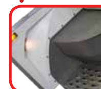
Дверь с интегрированной поворотной ступенькой и подсветкой Быстрый и безопасный вход/выход из КБР в полном обмундировании.
