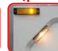
Дверь с интегрированной поворотной ступенькой и подсветкой Быстрый и безопасный вход/выход из КБР в полном обмундировании.
