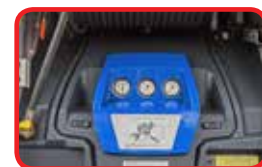
Новый насос NH-35. Эффективное тушение водой и пеной, работа с нормальным и высоким давлением. Управление в отсеке или из кабины водителя. Надежность насосов позволяет использовать даже морскую воду и пропускать тела до 8 мм.
