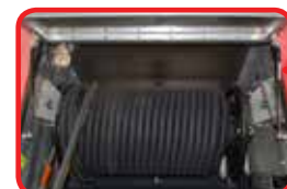
Удлиненная рукавная катушка (до 80 м) с электрическим механизмом намотки.
