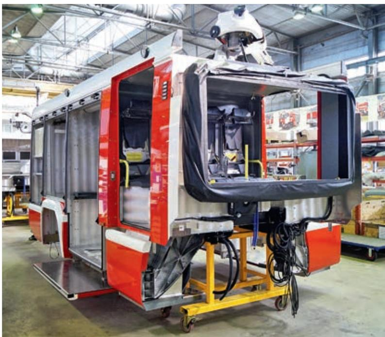
Сочленение между кабиной базового шасси и кабиной боевого расчёта – гибкое, на магнитах, удобное для пассажиров и обслуживания
