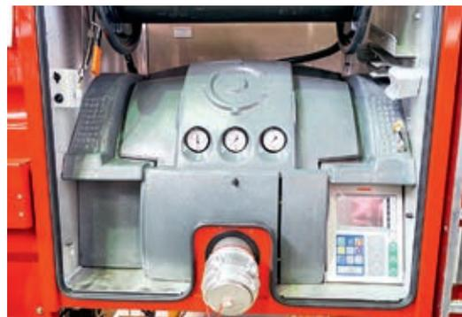
Насос по мере сборки машины «укрывают» кожухом, а в соседнем отсеке для него оборудован дополнительный отопитель
