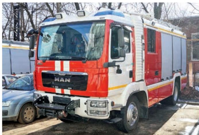
Автоцистерна АЦ 3,2-40/4 на шасси MAN TGM 13.290. После валютных скачков такие машины пользуются весьма ограниченным спросом, но у производителя в наличии есть как готовые машины, так и шасси для постройки новых
