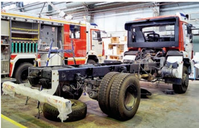
Подготовленные для монтажа надстроек шасси КАМАЗ-5387, поставляемые спутником челянинского завода – компанией «РИАТ»
