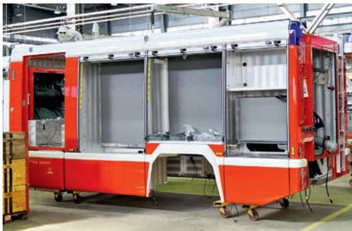
«Склеенные» надстройки до «свадьбы» с шасси перемещаются по цеху на специальных технологических тележках
