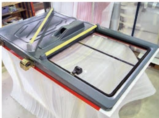
Дверь кабины боевого расчёта перед установкой на машину
