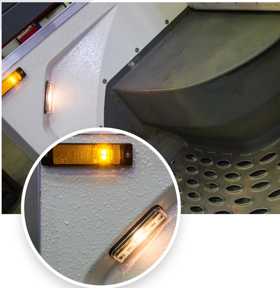
Кабина расчета АЦ оборудована автоматически выдвигающимися и подсвечивающимися ступеньками, при открывании двери.
