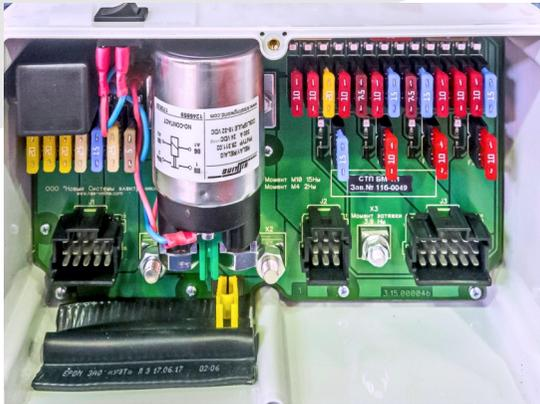
**Диагностика выхода из строя предохранителей пожарной надстройки** путем светодиодной индикации.
