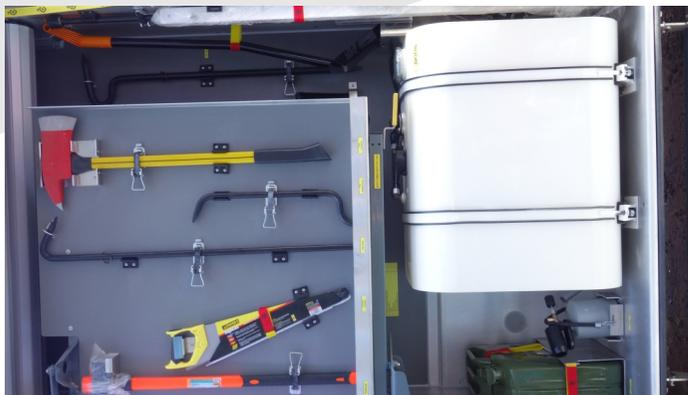
Топливный бак объемом 260 литров установлен в закрытом, герметичном отсеке (400 км пробега + 7 часов работы).
