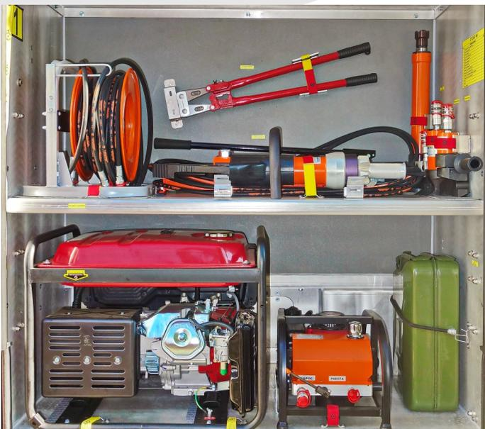
**Конструкция механизмов крепления** полок для ПТВ, находящегося в 1, 2, 3 и 4 отсеках предусматривает установку направляющих профилей, с целью изменения расстояний между полками в зависимости от габаритов перевозимого оборудования.
