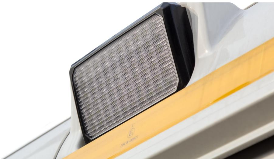
**Осветительные энергосберегающие светодиодные приборы** в верхней части кузова (сзади, слева и справа по бортам) расположены для освещения рабочей зоны вокруг АЦ в темное время суток.
