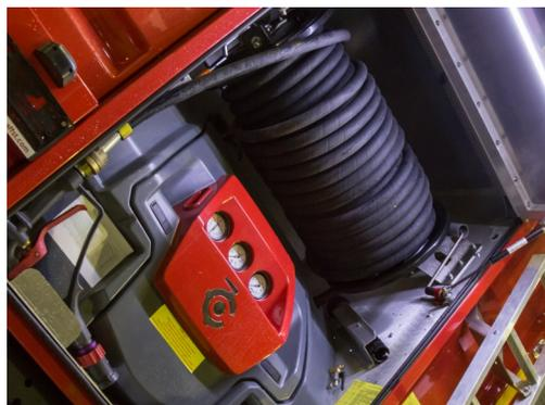
**Армированный рукав ВД** с увеличенной пропускной способностью длиной 60 м (с возможностью увеличения до 80 м) с сечением не менее 25 мм.
