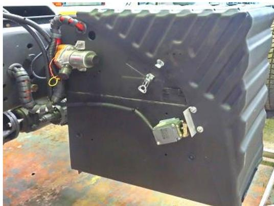
**Герметичный аккумуляторный отсек** позволяет установку всех типов АКБ.
